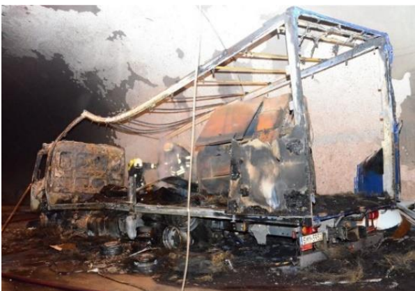
Abbildung 3: Brand eines Lkw im Tunnel Königshainer Berge in 2013 [10] (Fire of a truck in the tunnel Königshainer Berge in 2013)
