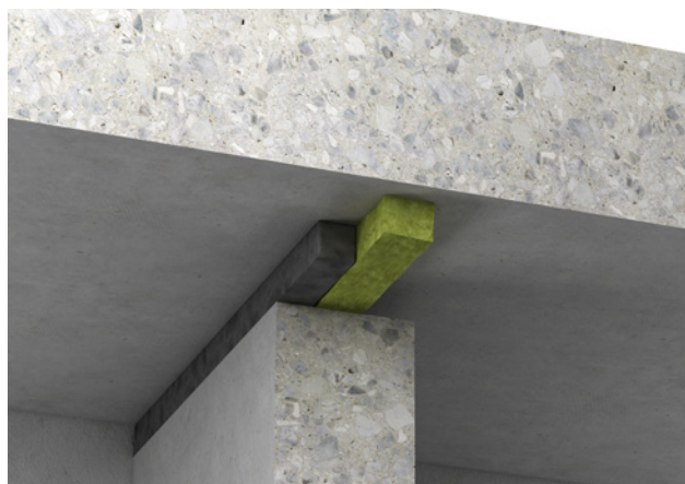
■ Aestuver™ FPM mastic mit Mineralwolle als Hinterfüllung
