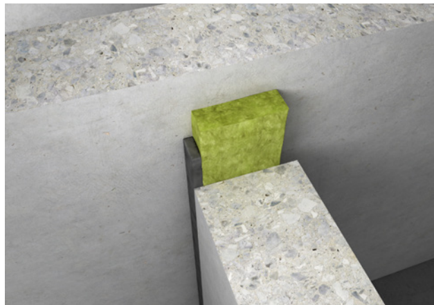
■ Aestuver™ FPM mastic einseitig mit Mineralwolle als Hinterfüllung – Variante 2 auch zweiseitig ausführbar
