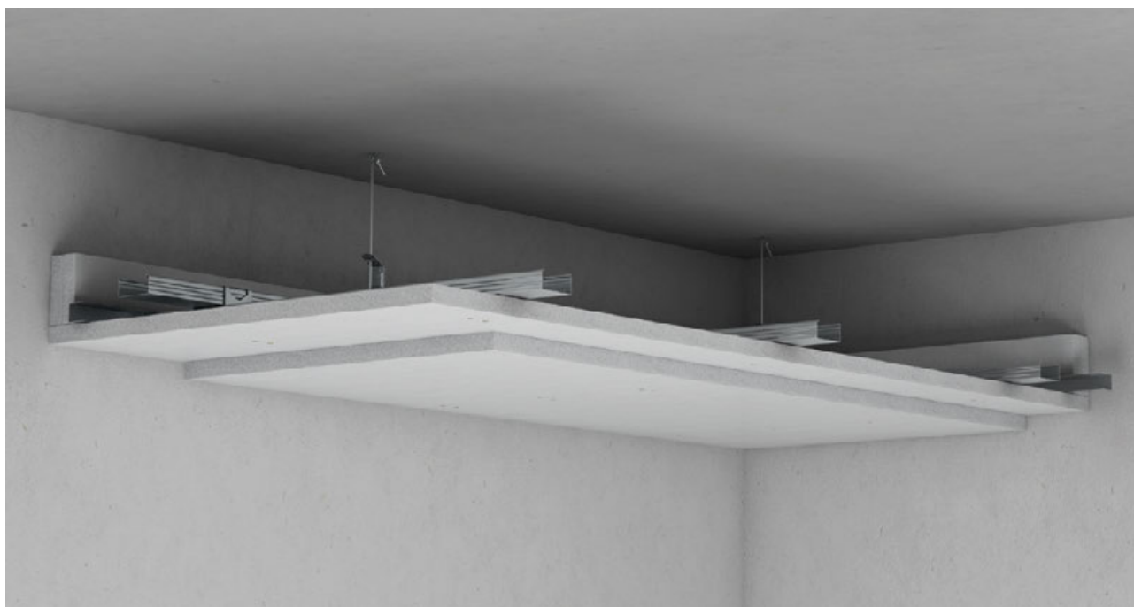
Wandanschluss - Querschnittschnitt
