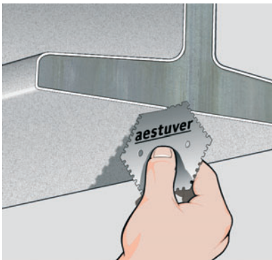
Kontrolle der Nassfilmdicke mit dem Messkamm
